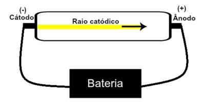
Quando um gás rarefeito, em baixa pressão, é submetido a uma alta tensão elétrica (por exemplo, 15000 V), produz um feixe de luz (composto por cargas elétricas) que sai do cátodo (polo negativo) em direção ao ânodo (polo positivo).
